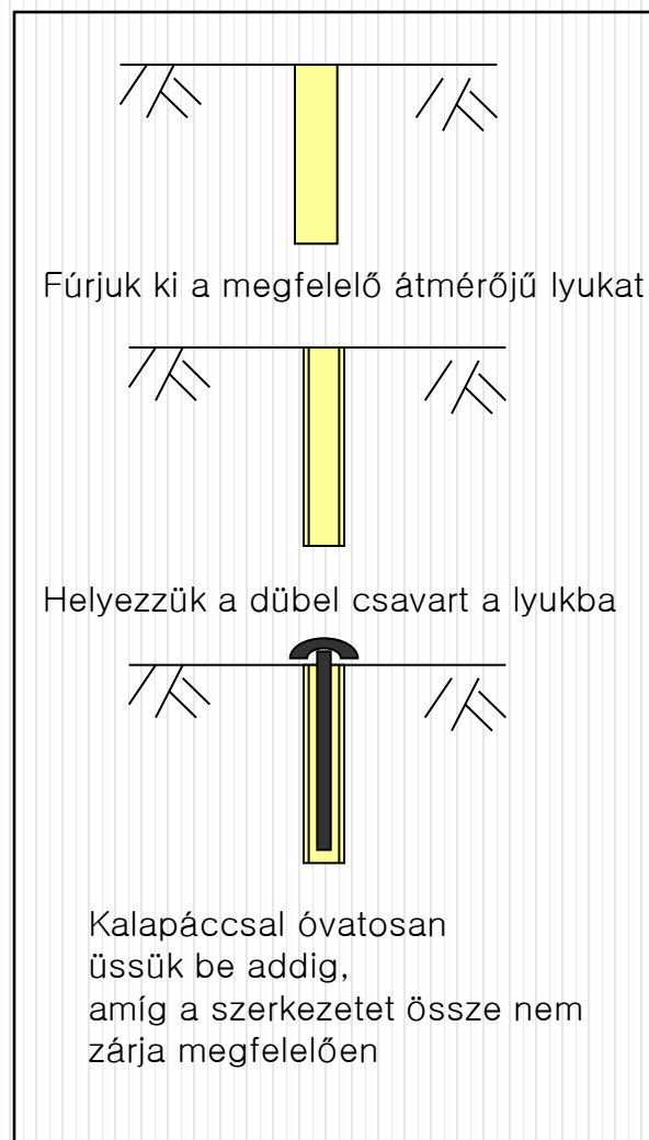
Keresztmetszet rögzítő beütő csavar
